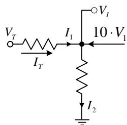
Na osnovu uprošćene šeme se vidi da je  $I_2 = I_1 + 10V_1 = V_1 / R_1 + 10V_1 = 10^{-3}V_1 + 10V_1 \approx 10V_1$
